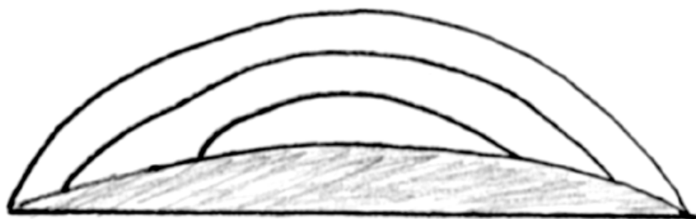
Рис. 4-1-6. Изменение формы капли от времени для раствора белка при отсутствии перемешивания (гипотетический случай). Имеется залипание границы (пиннинг).
