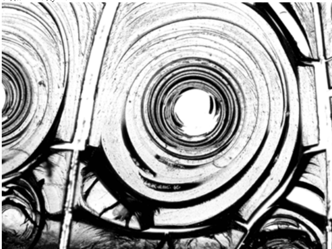
Рис. 2-10-11. Концентрические трещины в ячейке. Поле зрения 0,3мм.
