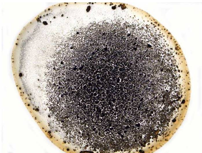
Рис. 4-1-9. Кристаллограмма раствора кофе. Проходящий свет. Поле зрения 10мм.
