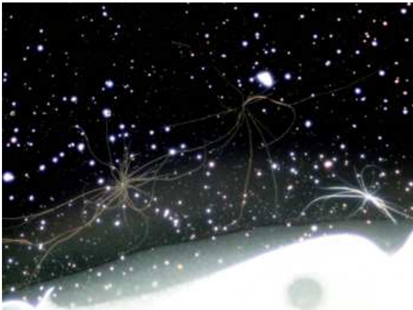
Рис. 2-13-3. Кристаллы внешние нитевидные. Темное поле. Поле зрения-1,5мм.
