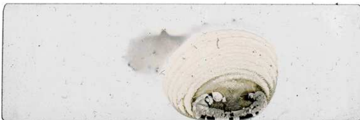
Рис. 5-8-4. Кристаллизация на наклонной поверхности.
