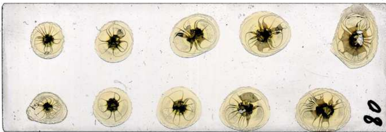
Рис. 5-3-12. Кристаллизация при температуре 80 градусов. Произошло практически полное стягивание всего белка к центру.
