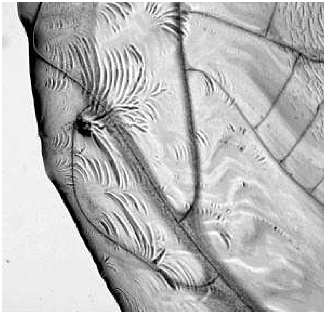
Рис. 2-3-1. Морщины в краевой зоне капли. Боковое освещение. Поле зрения 2мм.
