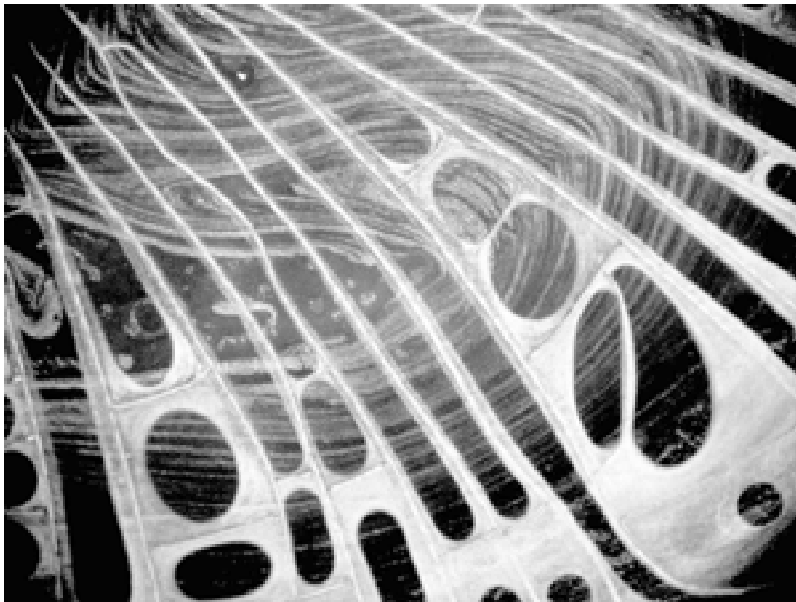
Рис. 2-3-2. Структуры на поверхности капли. Темнопольное освещение. Поле зрения 3мм.
