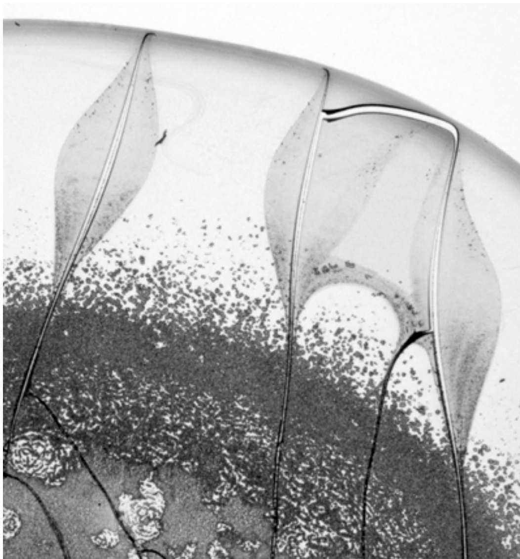
Рис. 2-10-9. Структура типа «лист» в сформированной капле. Поле зрения 2мм.
