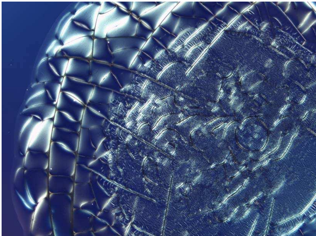
Рис. 3-4-1. Напряжения вдоль трещин в высушенной капле. Поляризованный свет. Поле зрения 3мм.
