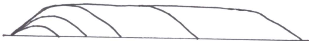
Рис. 5-1-2. Изменение формы капли при увеличении объема капли.
