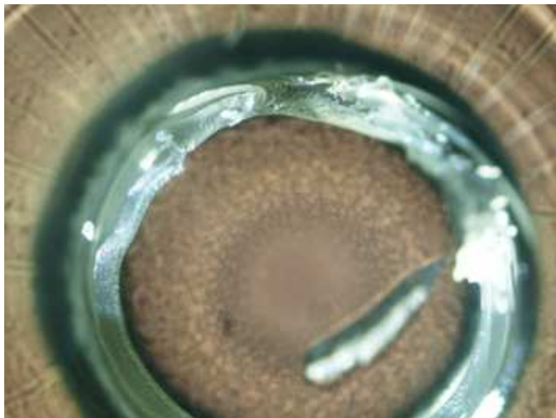
Рис. 5-3-6. Срез бугра в центре капли сыворотки, высохшей при температуре 80 °С. Видно строение тонкостенного пузырька. Поле зрения 3мм.
