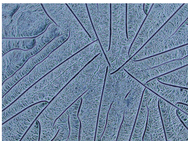
Рис. 2-8-2. Трещины и узкие псевдотрещины. Светлое поле, темное поле, фазовый контраст. Поле зрения 2мм.
