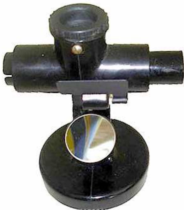
Рис. 10-5-1. Агглютиноскоп (agglutinoscopum) это прибор, при помощи которого определяются реакции агглютинации и производится визуальная оценка осадка, образовавшегося в результате реакции при боковом освещении.
