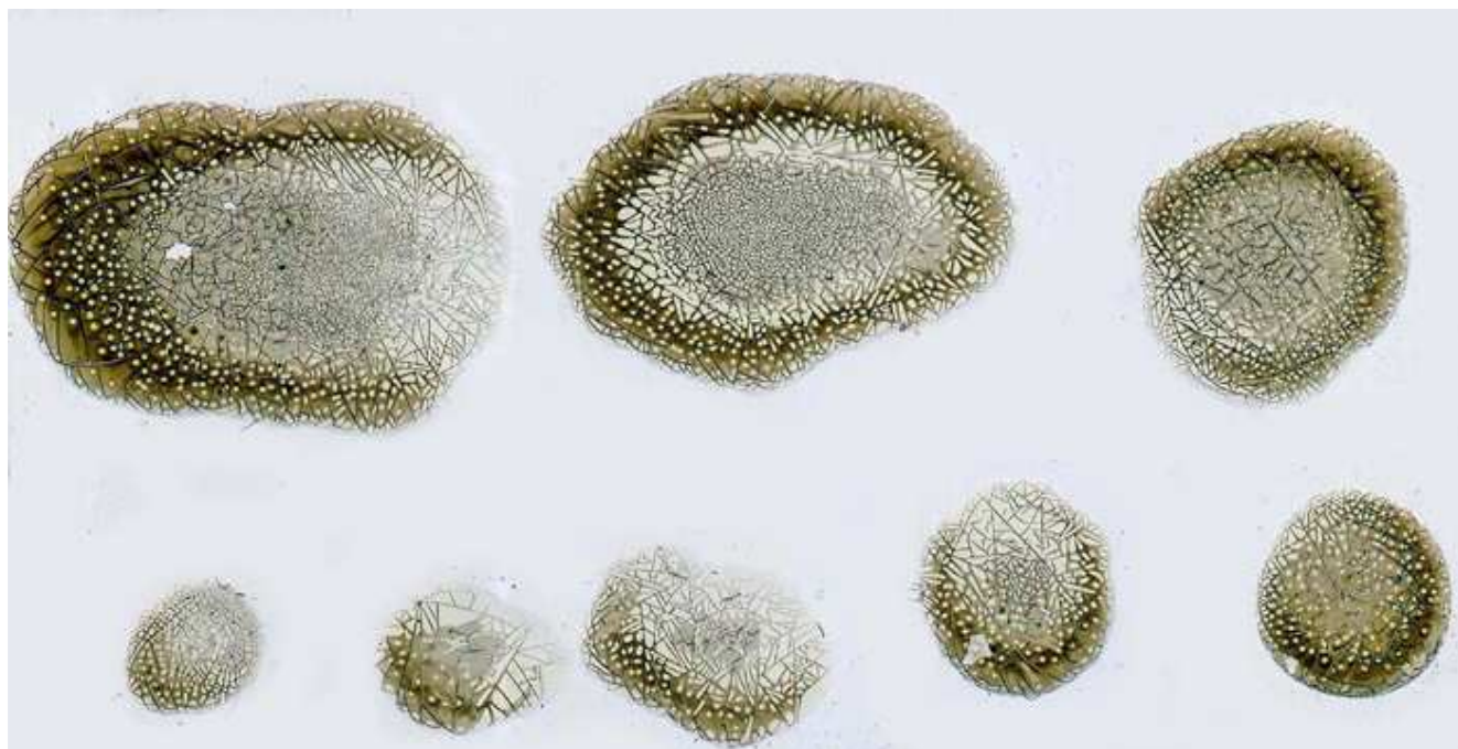
Рис. 5-1-11. Формирование структур при разных объемах капли.
