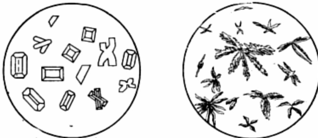
Рис. 3-2-1. Кристаллы соли магния ( $MgNH_4PO_4 \cdot 6H_2O$ ), образующиеся при медленной (слева) и быстрой (справа) кристаллизации.
