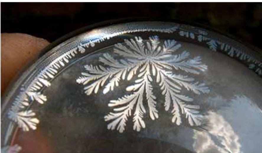
Рис. 9-3-5. Расклеивание склеенной оптической линзы.
