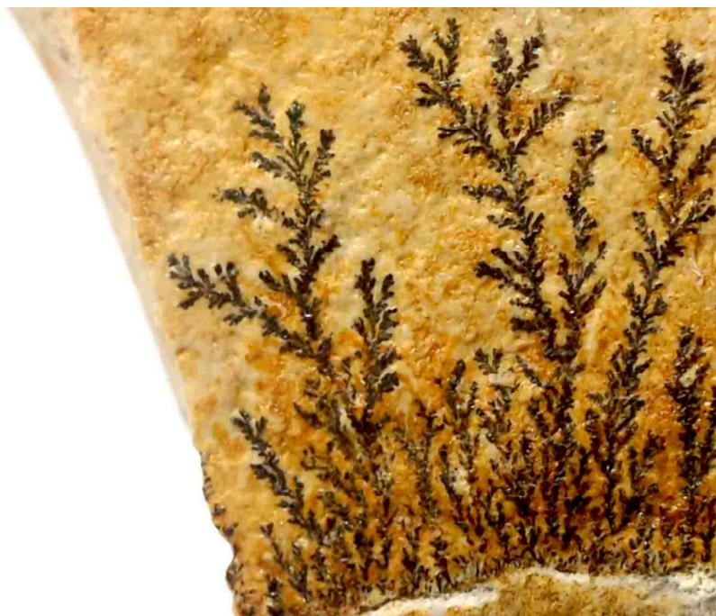
Рис. 3-9-1. Плоские (двухмерные) дендриты диоксида марганца, образовавшиеся в тонкой трещине. Отраженный свет. Поле зрения 30 мм.
