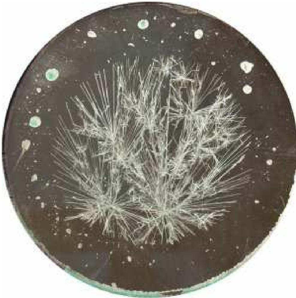
Рис. 2-5-5. Кристаллограмма чистого раствора хлорида меди без добавления других веществ.
