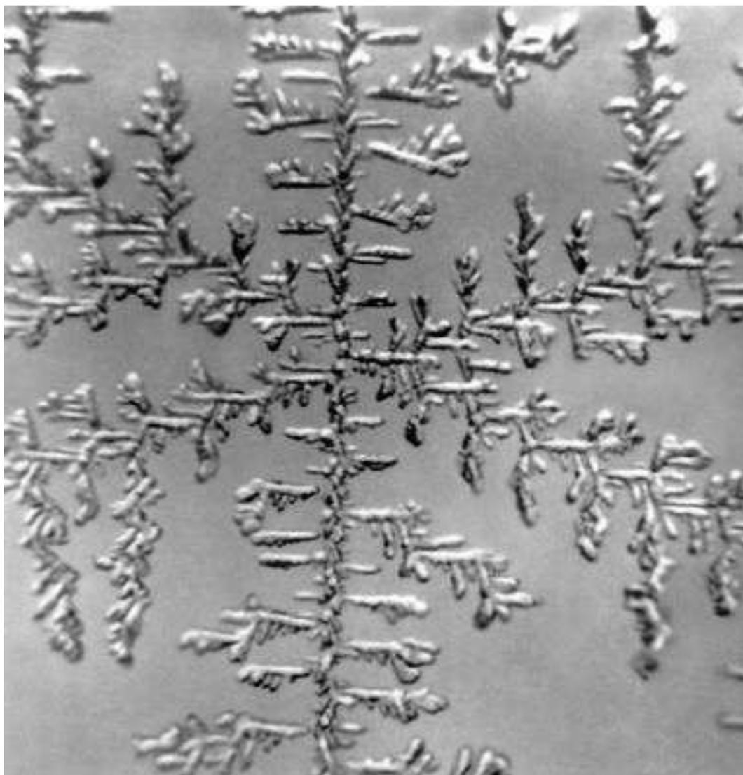
Рис. 3-8-5. Двумерные дендриты хлористого аммония.
