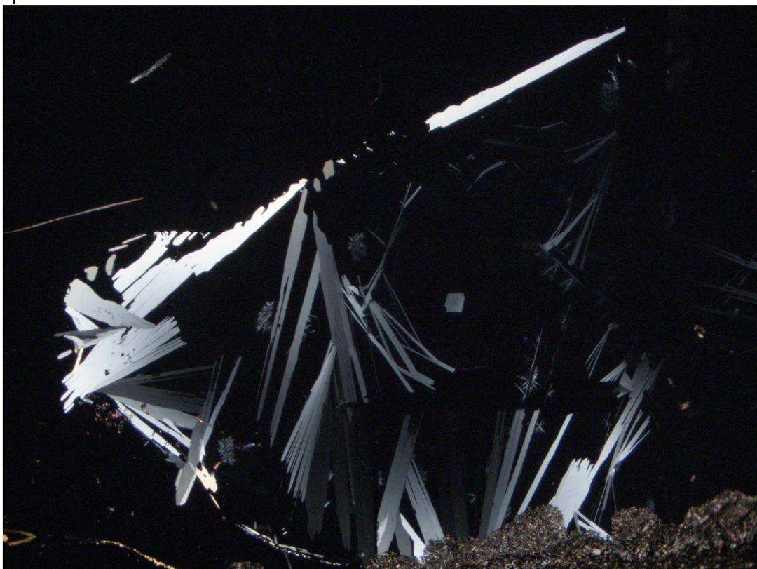
Рис. 5-2-2. Кристаллизация мочевины методом закрытой капли. Поляризованный свет. Поле зрения 10 мм.
