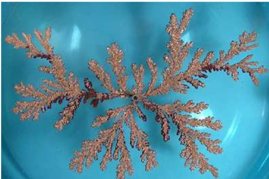
Рис. 3-6-1. Дендритный кластер, образованный из раствора сульфата мети в электролитической ячейке.
