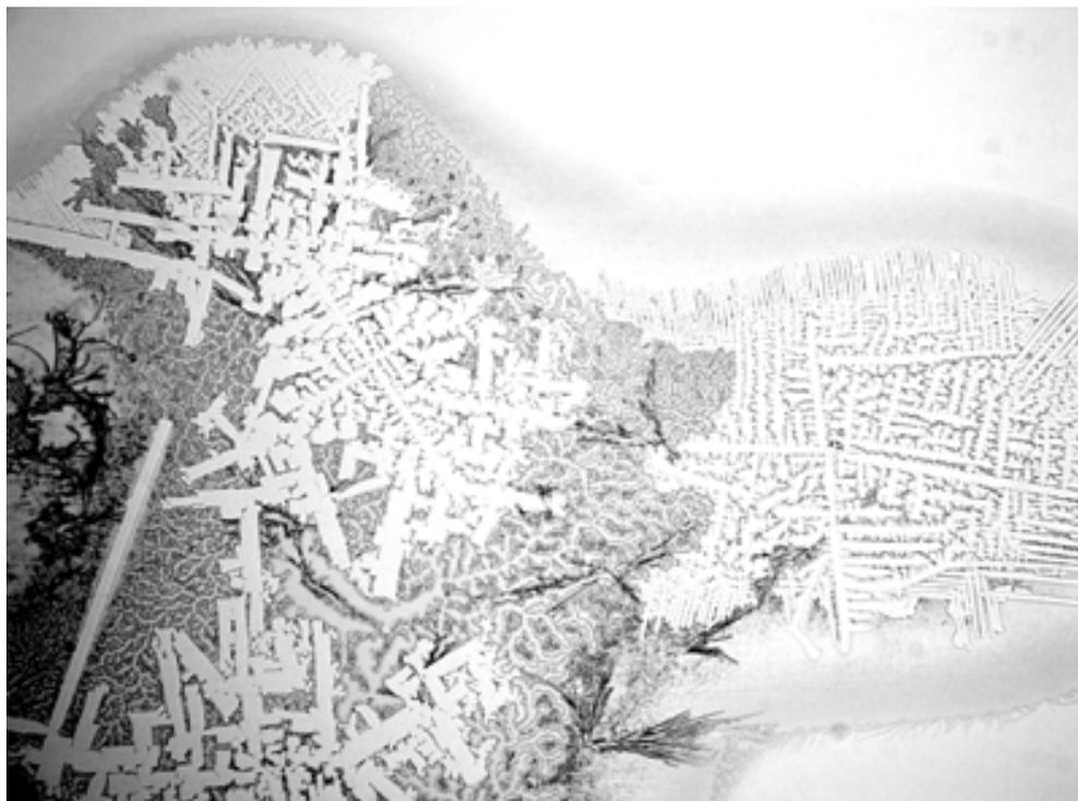
Рис. 5-3-13. Раствор альбумина с добавлением соли NaCl. Поле зрения 1,5 мм.
