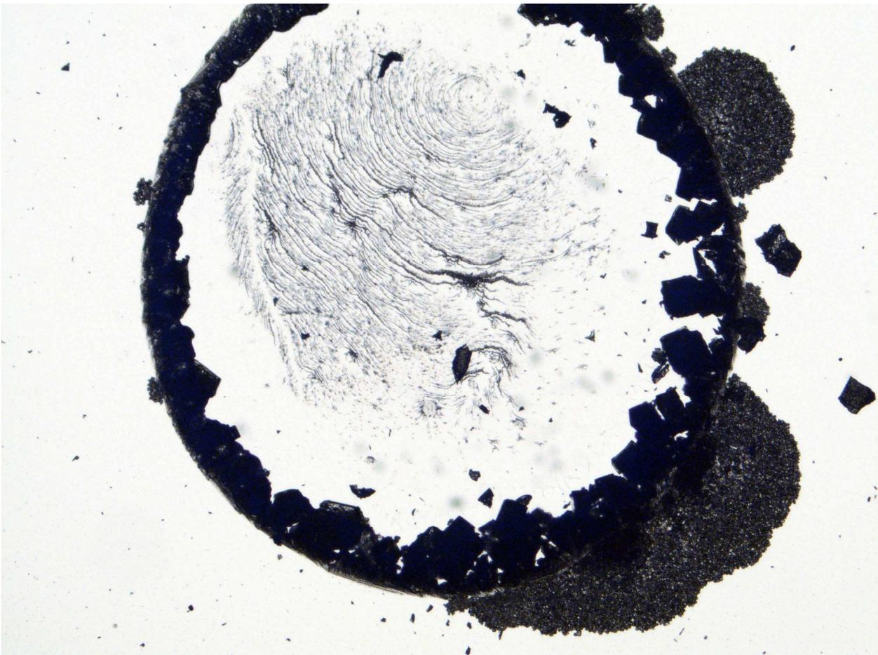
Рис. 4-2-4. При кристаллизации соли возможно разрастание кристаллов за пределами капли. Проходящий свет. Поле зрения 5 мм.
