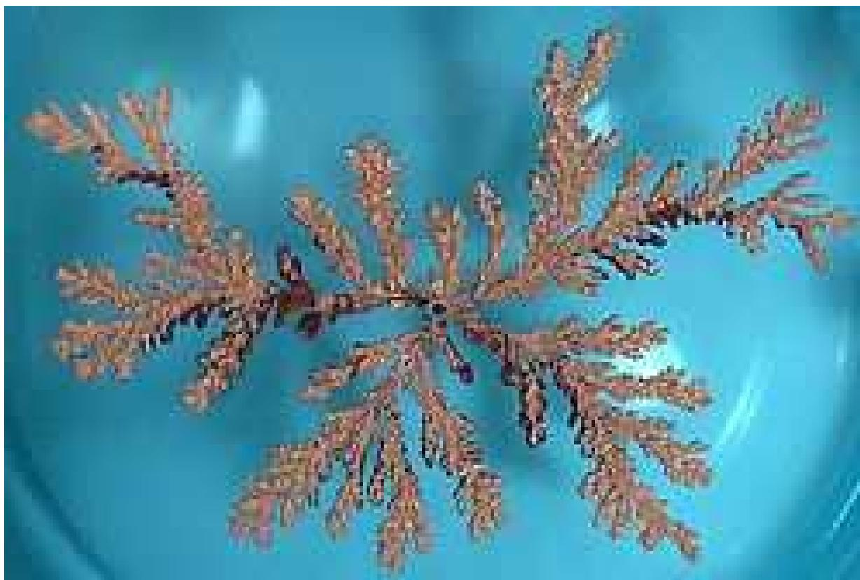
Рис. 9-5-2. Дендритный кластер, образованный из раствора сульфата меди в электролитической ячейке.
