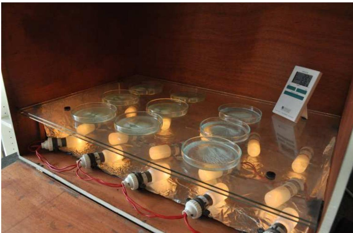
Рис. 5-6-11. Установка для кристаллизации вина. Установлен прибор для контроля температуры и влажности.
