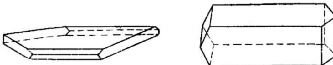
Рис. 5-5-5. Кристаллы гидратной и ангидридной глюкозы.
