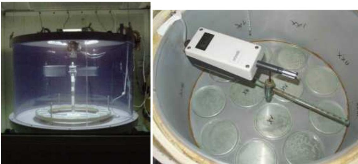
Рис. 2-5-4. Установка для изучения процессов кристаллизации. Сама установка находится в помещении, которое полностью изолировано от окружающей среды.
