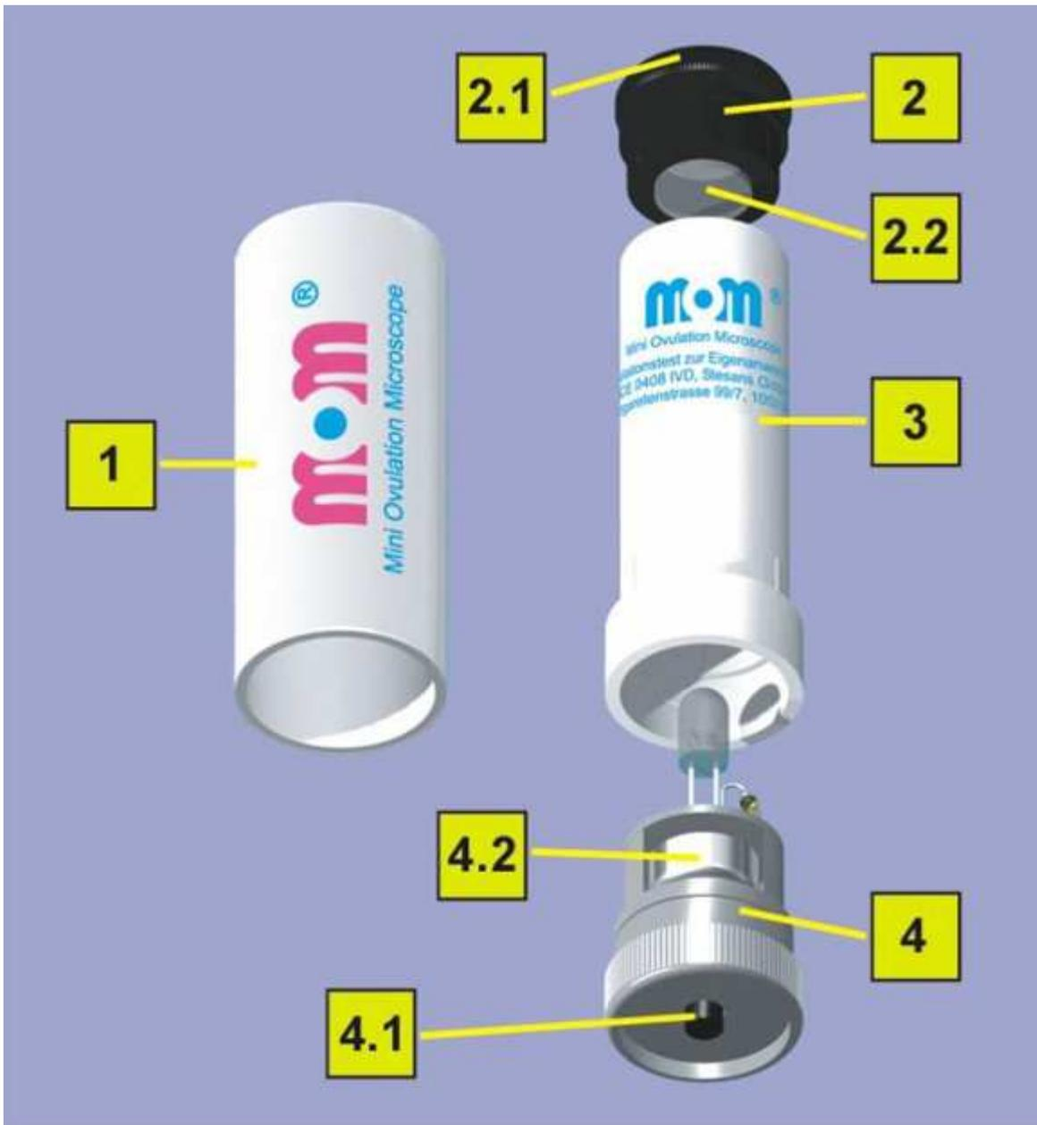
Рис. 7-2-3. Мини-микроскоп MOM. 1-футляр, 2-окуляр, 2.1-фокусирующее кольцо, 2.2-предметное стекло для пробы слюны, 3-корпус мини-микроскопа, 4-источник света, 4.1-кнопка подсветки, 4.2-две батарейки SR44. Микроскоп имеет увеличение 52х.
