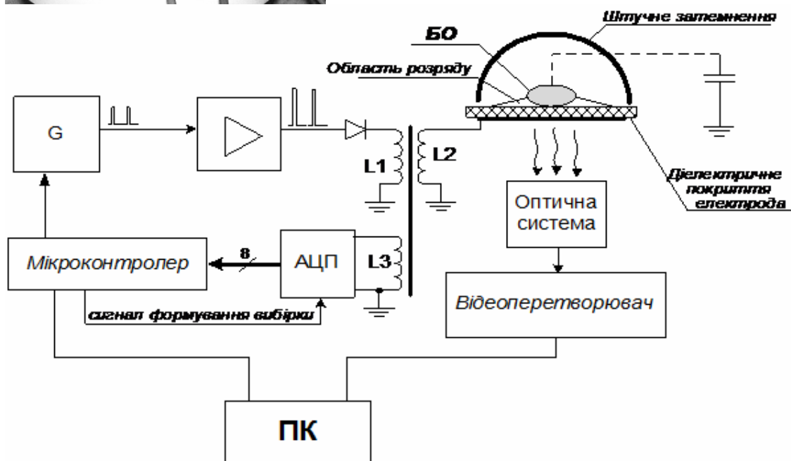
Рис. 3-5-1. Внешний вид и схема установки для ГРВ-исследований.
