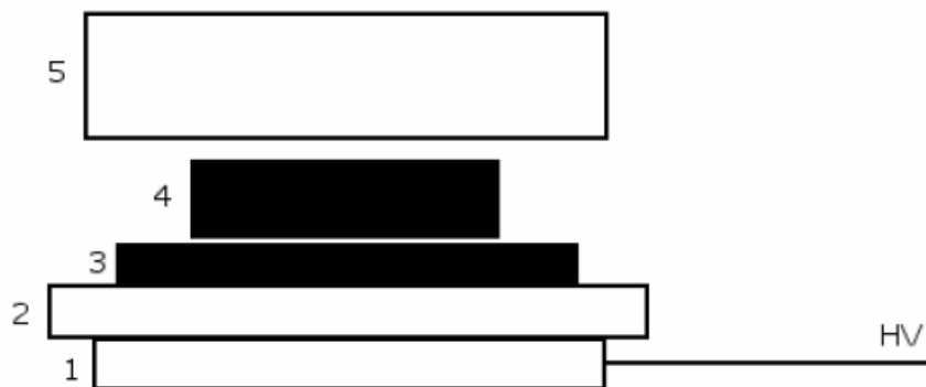
Рис. 7-1-89. Схема установки. 1-металлический электрод. 2-изолятоор, 3-фотопленка, 4-объект, 5-электрод.
