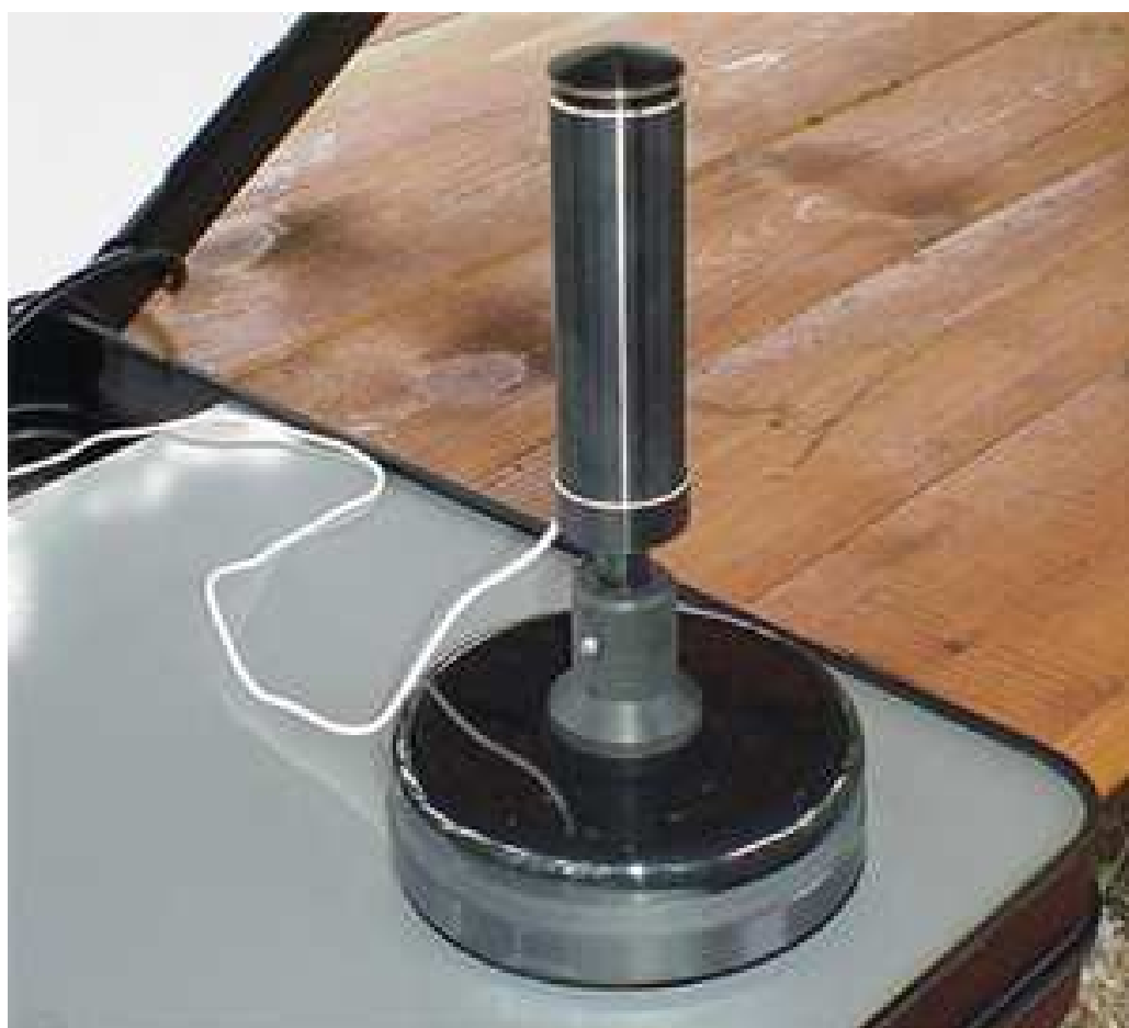
Рис. 5-2-1. Экспериментальная установка для измерения газоразрядных изображений жидкости методом подвешенной капли. 1-окно прибора для исследования ГРВ объектов. 2-капля жидкости, 3-шприц, 4-заземление.
