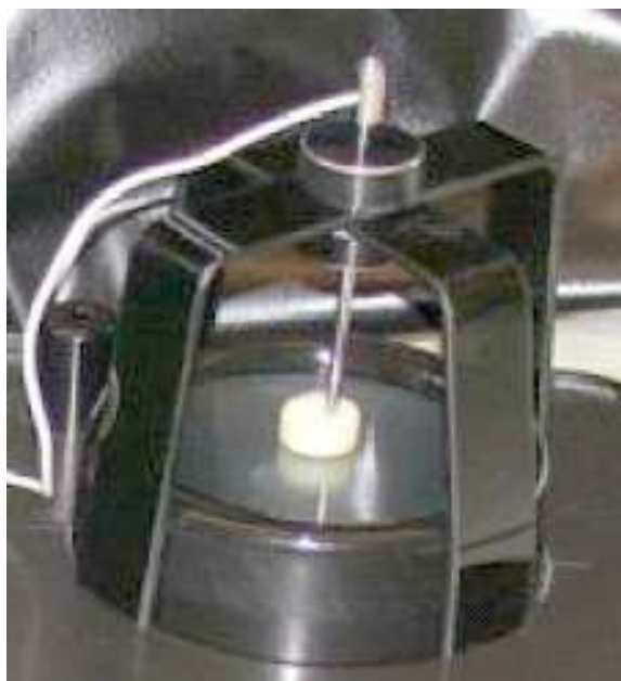
Рис. 4-5-10. Устройство для фиксации кусочков фруктов при регистрации свечения.
