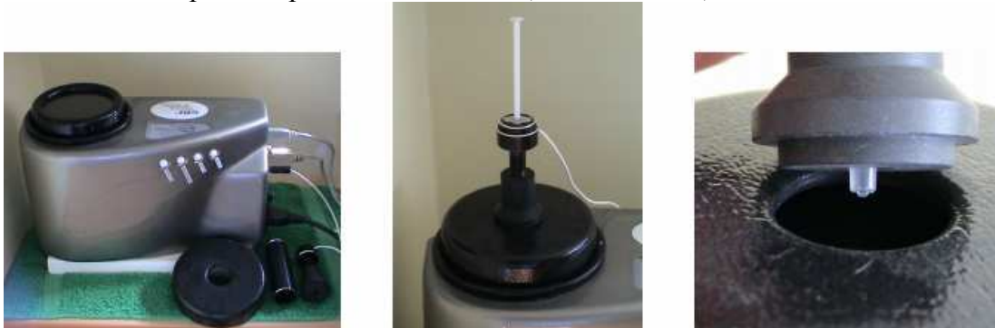
Рис. 5-2-24. Кирлиан камера. Регистрация осуществлялась при напряжении 10, 15, 17, 24 кВ, частота 1000Гц, длительность импульса 10мкс.
