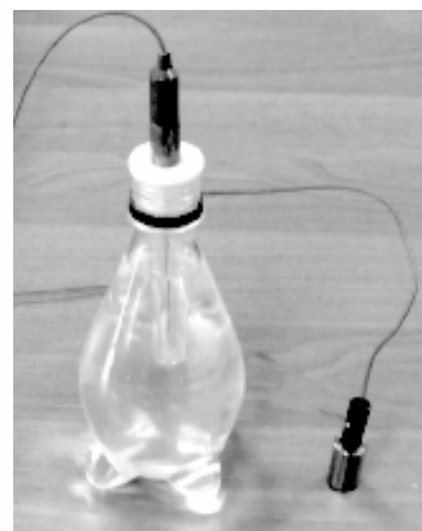
Рис. 5-3-2. Исследование жидкости в стаканчике с электродом, 1-ГРВ камера, 2-металлический цилиндр, 3-исследуемая жидкость, 4-платиновый электрод, 5-регистрируемый разряд. На фотографии изображен платиновый электрод, помещенный в стаканчик с жидкостью и соединенный с тест-объектом.
