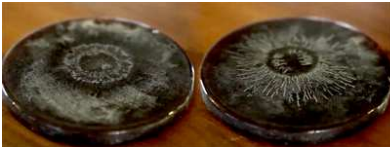
Рис. 1-9-1. Пылевые фигуры от положительного и отрицательного круглого электрода.
