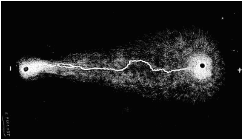
Рис. 1-3-6. Разряд между двумя электродами, отрицательный электрод слева, положительный электрод справа.
