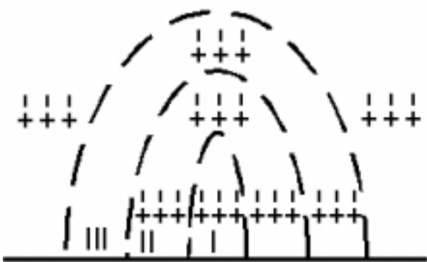
Рис. 1-9-16. Схематическое изображение развития ионизационных процессов в промежутке с большим перенапряжением (наносекундный интервал времени).
