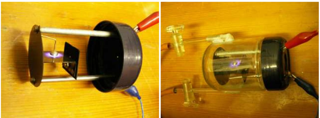
Рис. 1-8-7. Герметичная газовая Кирлиан-камера ГГКК-1.
