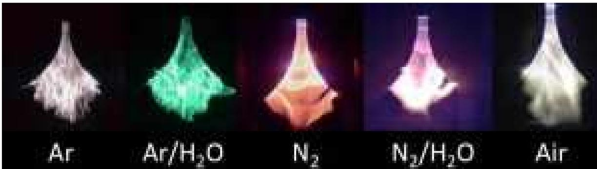
Рис. 1-8-10. Цвет стримеров в различной газовой среде.
