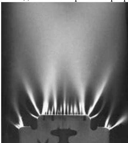
Рис. 3-3-5. Фотография коронного разряда с бритвенного лезвия при подаче на него положительного электрического потенциала 10кВ. Фотография получена с выдержкой 10с.
