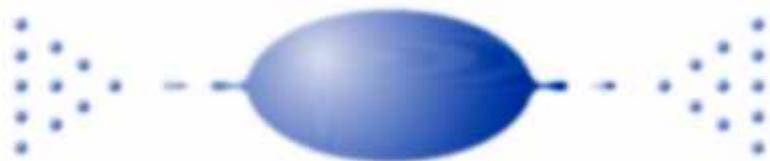
Рис. 3-4-2. Схематическое изображение неустойчивой по отношению к собственному заряду капли, сбрасывающей избыточный заряд путем эмиссии высокодисперсных сильно заряженных капелек.
