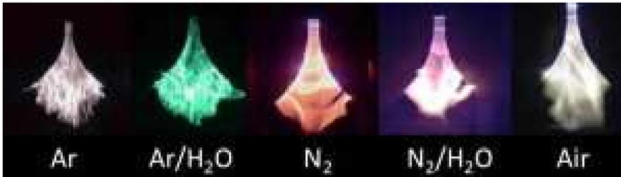
Рис. 1-11-7. Цвет стримеров в различной газовой среде.
