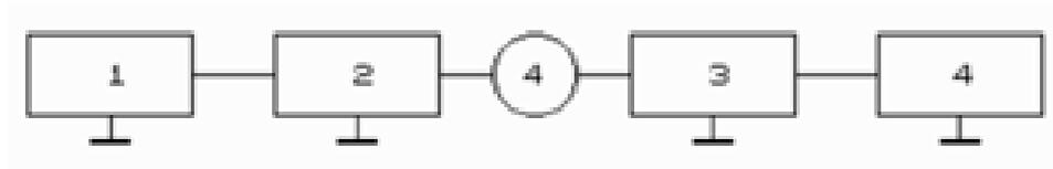
Рис. 5-3-1. Схема устройства: 1-генератор высоковольтных высокочастотных импульсов; 2-высоковольтный электрод; 3-объект исследований; 4-преобразователь импульсов разрядного тока в напряжение; 5-измеритель напряжения.
