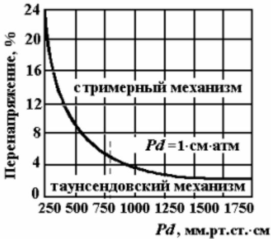
Рис. 1-10-4. Области таунсендовского и стримерного разрядов. С увеличением  $Pd$  растет число электронов в лавине, и поэтому необходимо меньшее перенапряжение.
