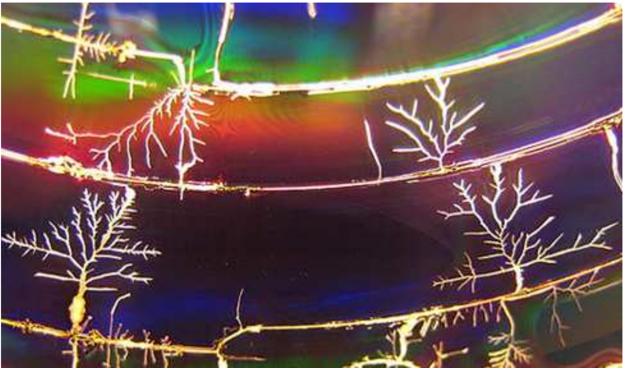
Рис. 3-5-6. Разрушение поверхности CD диска в микроволновой печи.
