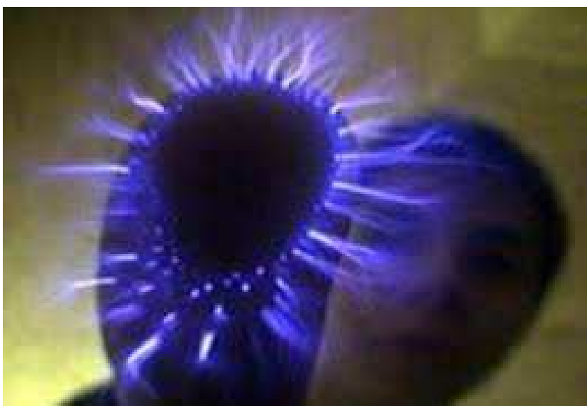
Рис. 5-1-3. Стример состоит из прямолинейного канала, который разветвляется на поверхности диэлектрика. -----
