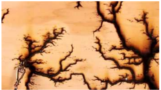
Рис. 3-5-2. Распространение разряда по деоветной поверхности.
