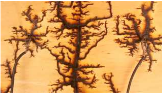
Рис. 3-5-2. Распространение разряда по деоветной поверхности.
