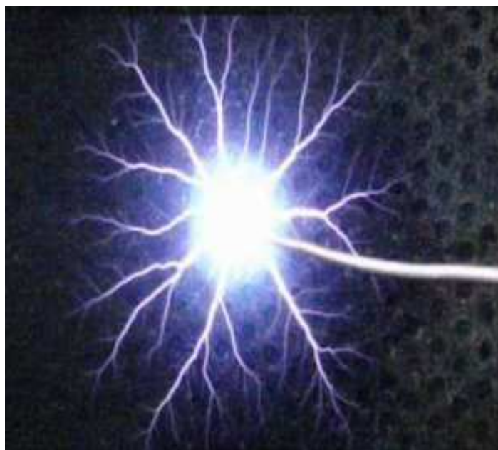
Рис. 3-4-2. Распространение разряда по поверхности ткани, смоченной водой.
