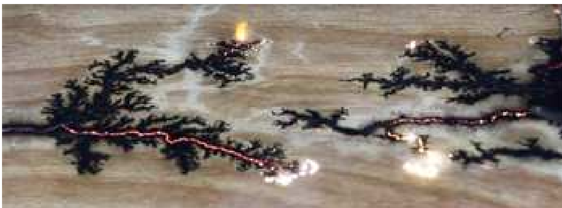
Рис. 3-5-1. Распространение разряда между двумя электродами по поверхности деревянной доски, смоченной раствором соды. Два снимка сделаны с интервалом в 10 секунд.
