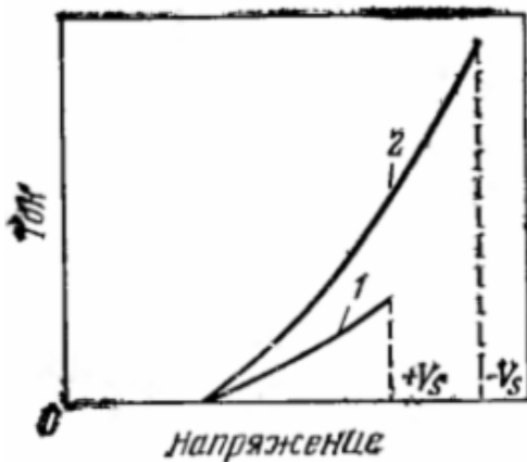
Рис. 2-2-6. Зависимость тока от напряжения при коронном разряде, 1-положительный, 2-отрицательный.
