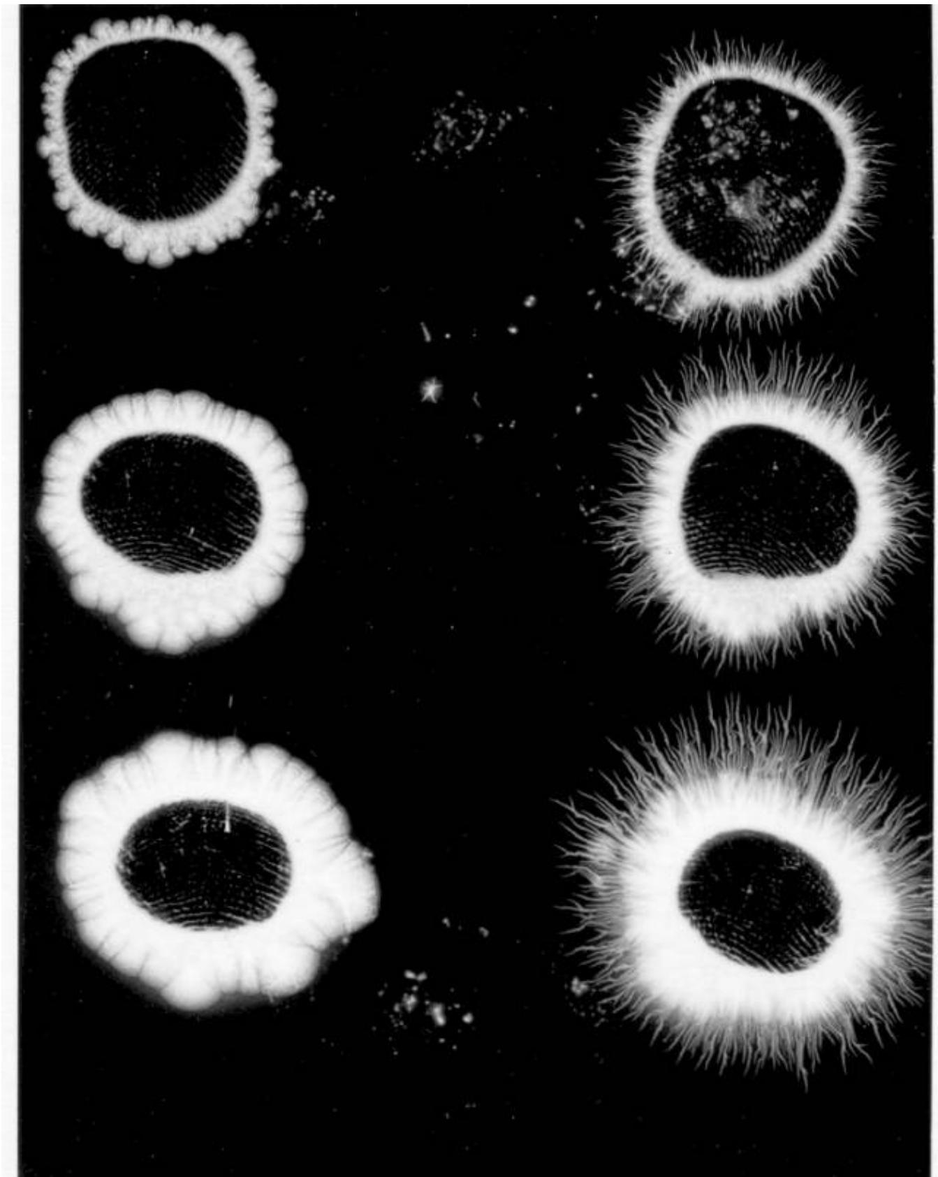
Рис. 1-1-6. Зависимость качества снимка от величины напряжения. Слева отрицательная корона, справа положительная корона. -верхний ряд низкое напряжение (10кВ), -средний ряд среднее напряжение, -нижний ряд высокое напряжение.
