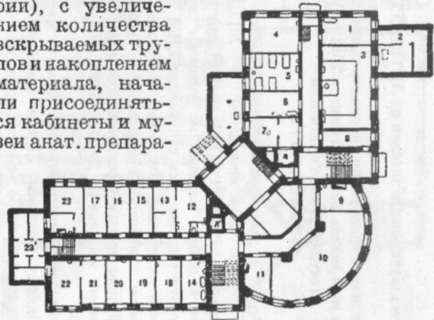
Новый анат. ин-т 1 МГУ. План цокольного этажа: 1—приемная для трупов; 2—гробовая; 3—хранение трупов; 4—консервировочная; 5—помещение с баками; 6—инъекционная; 7—крематорий; 8—замораживание; 9—мацерационная; 10—публичный музей; 11—кухня; 12—прачечная; 13—гладильная и склад для белья; 14—ванны и души; 15, 16, 17—склады для препаратов, хим. веществ и посуды; 18—гипсовая; 19—муляжная; 20—слесарная; 21—монтажная; 22, 23—квартиры служителей; 23¹—дрова, ледники.
