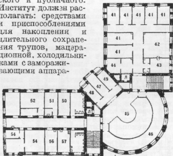
План 3-го этажа: 41, 43—кабинеты для научных работников; 42—гистологическая; 44—хранение трупов; 45—аудитория; 46—демонстраториум; 47—проекционные аппараты; 48—лекторская; 49—подготовительная; 50—кабинет проектора; 51—микрофотография; 52—рентгеновская; 53—гистологическая; 54—кабинет библиотекаря, справочная, читальня и книгохранение; 56—кабинет директора; 57—химическая; Л—лифт.
