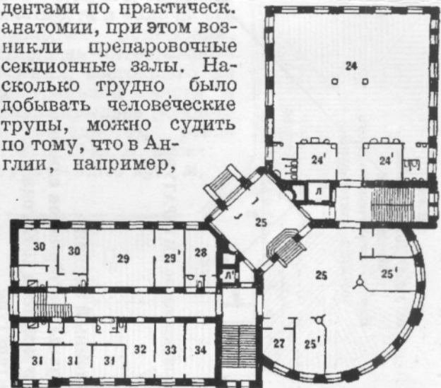
План первого этажа: 24—секционная; 24¹—хранение трупов; 25—вестибюль; 25¹—хранение платья и халатов; 27—швейцар; 28—дежурная служителей; 29, 29¹—антропометрический кабинет; 30, 31—квартиры; 32—приемная директора; 33—завхоз; 34—канцелярия; Л—лифт.
